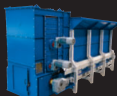
Aufgäbe- und Dosierbunker
