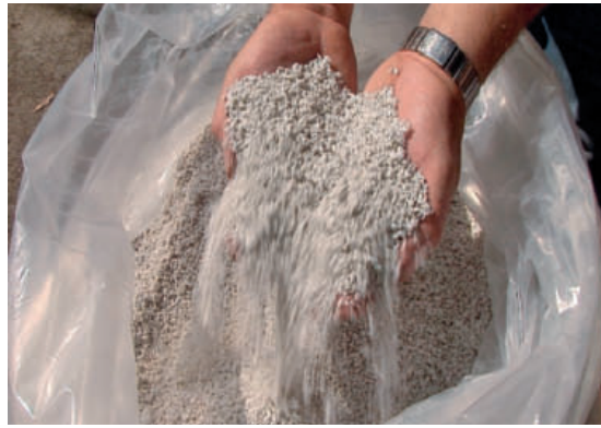
4 Агломерат с высокой плотностью гранул Фото: Herbold Meckesheim
