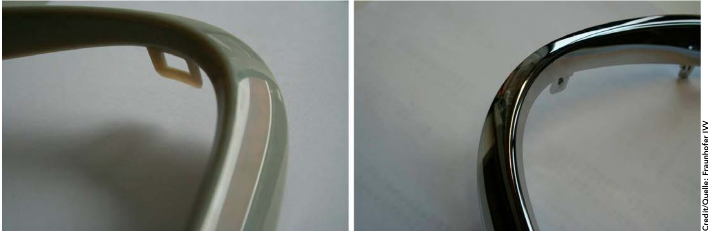
Figure 3: Surface of an injection moulding produced from recovered ABS regranulate prior to and after re-electroplating ▲ Bild 3: Oberfläche des Spritzgussteils aus zurückgewonnenem ABS-Regranulat vor und nach der Re-Galvanisierung
