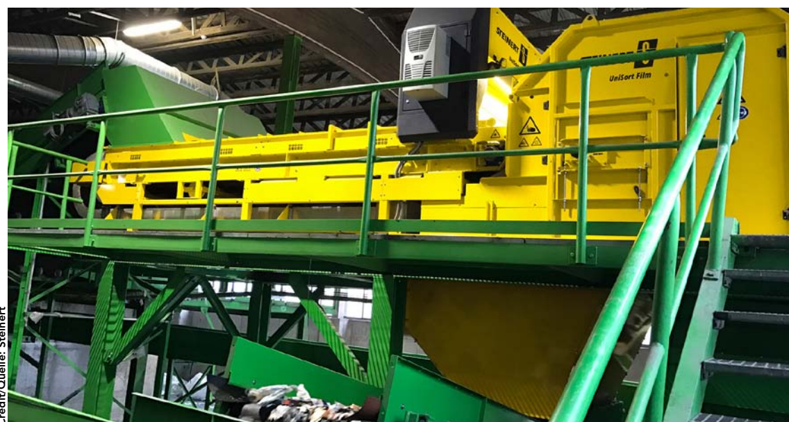
◀ Steinert’s sorting machine UniSort Film sort several tons of plastics per hour fully automatically Die Sortiermaschine UniSort Film von Steinert trennt mehrere Tonnen Kunststoff pro Stunde vollautomatisch
