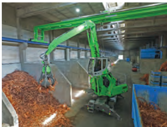
1 И в сортировке материалов, и в погрузке в грузовые автомобили. Благодаря подведенному сверху электропитанию электроэкскаваторы SENNEBOGEN 825 универсальны в применении в производственных цехах.
