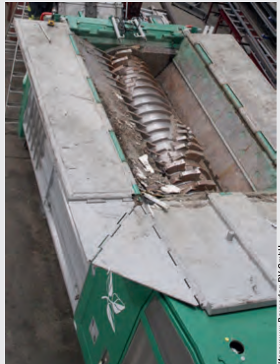
Вид на барабан «Терминатора» ▲
