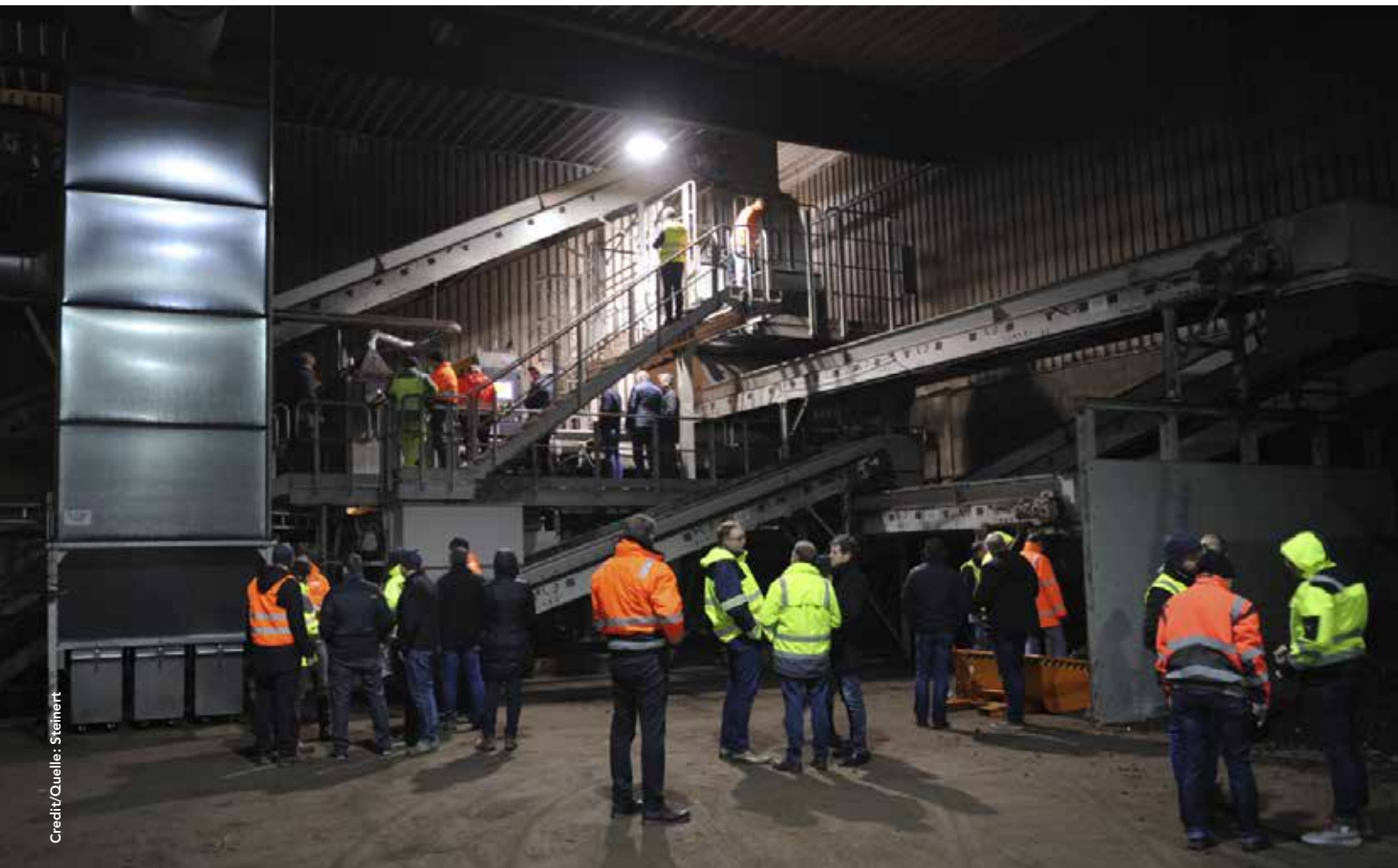
UniSort Black in use at KDM in Ratingen. It sorts films, dark and black plastics, metals, ▲ broken glass, stones and ceramics from green waste and structural material UniSort Black im Einsatz bei der KDM in Ratingen. Sie sortiert Folien, dunkle und schwarze Kunststoffe, Metalle, Glasbruch, Steine und Keramik aus Kompost und Strukturmaterial
