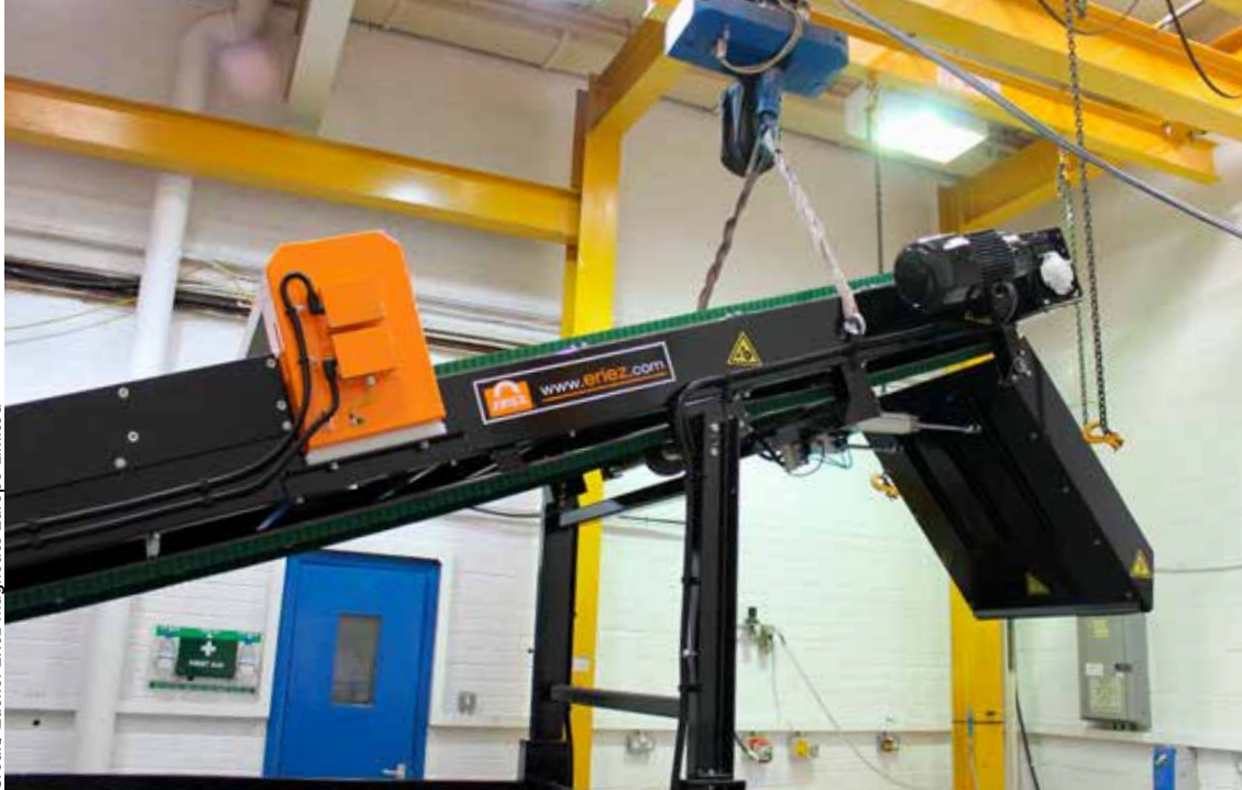
Pneumatic Reject System on the E-Z Tec 9000 R Metal Detector Pneumatisches Ausschusssystem auf dem E-Z Tec 9000 R Metalldetektor
